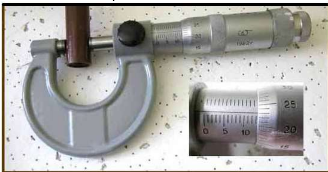
Рис. 38. Измерение детали микрометром
