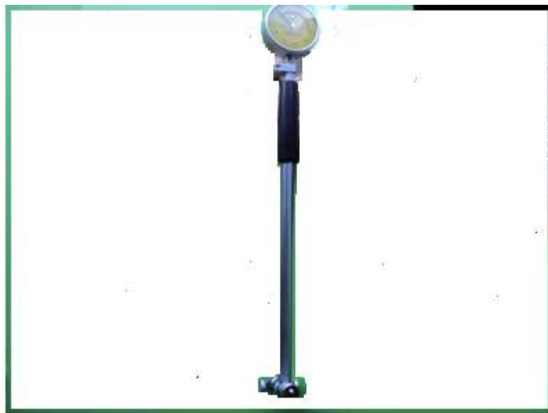
Рис. 50. Установка индикатора часового типа в штангу
