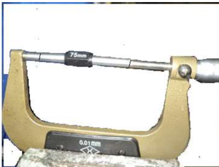
Рис. 46. Проверка точности микрометра эталонным калибром
