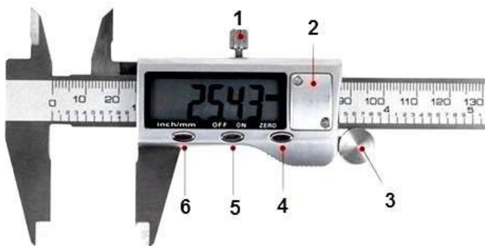
Рис. 12. Устройство цифрового штангенциркуля:
