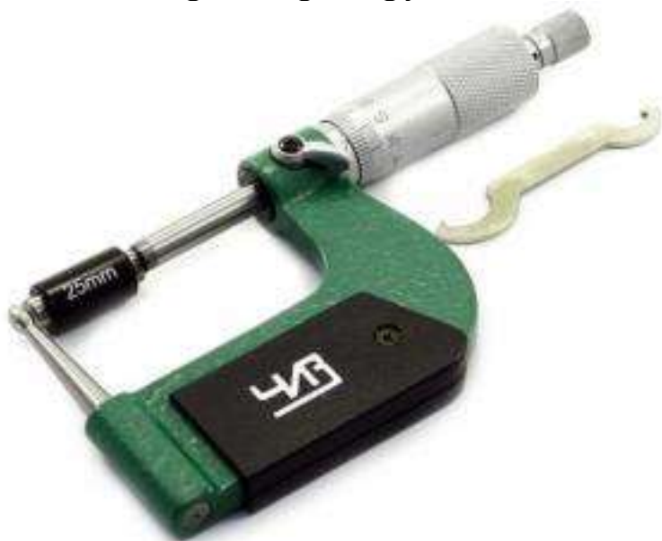
Рис. 28. Микрометр трубный МТ
