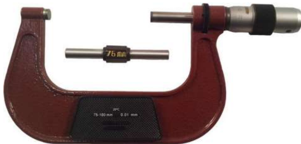
Рис. 22. Микрометр с эталонным вкладышем
