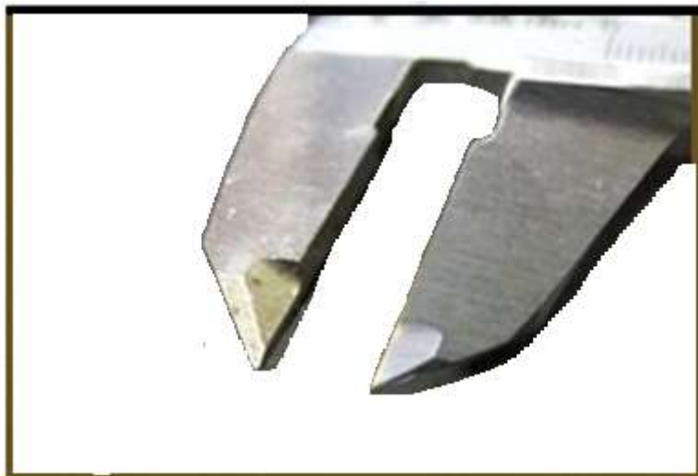
Рис. 18. Заточка губок штангенциркуля для разметки
