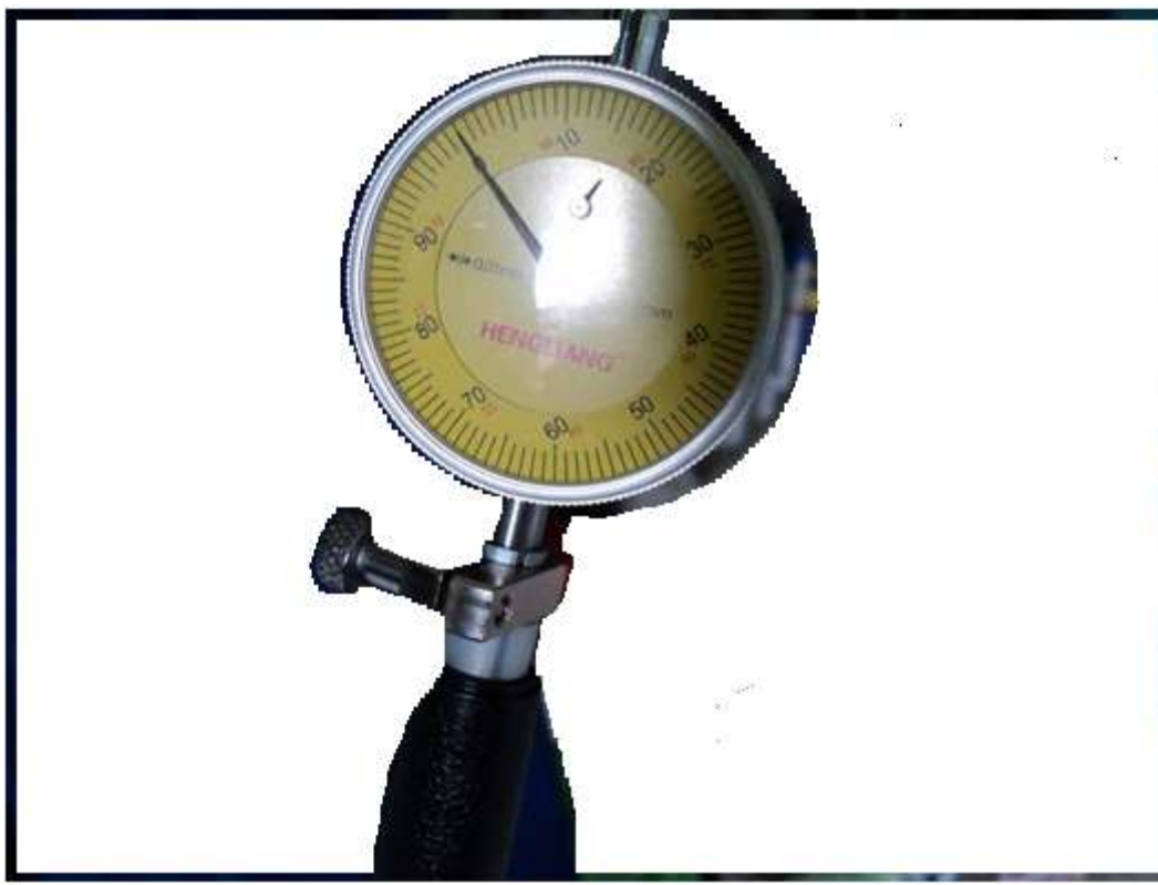
Рис. 53. Установка «0» на индикаторе часового типа
