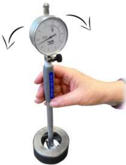
Рис. 44. Настройка индикаторного нутромера
