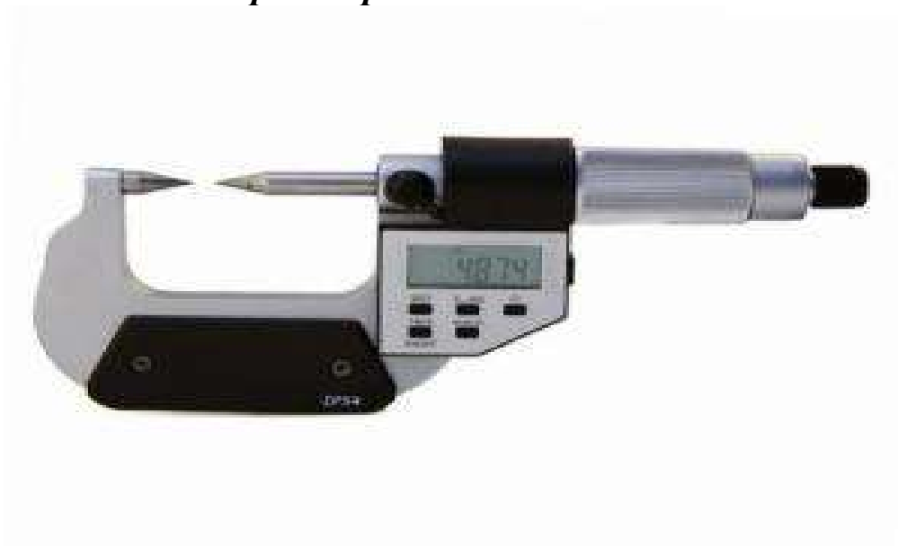
Рис. 33. Микрометры точечные МК-ТП
