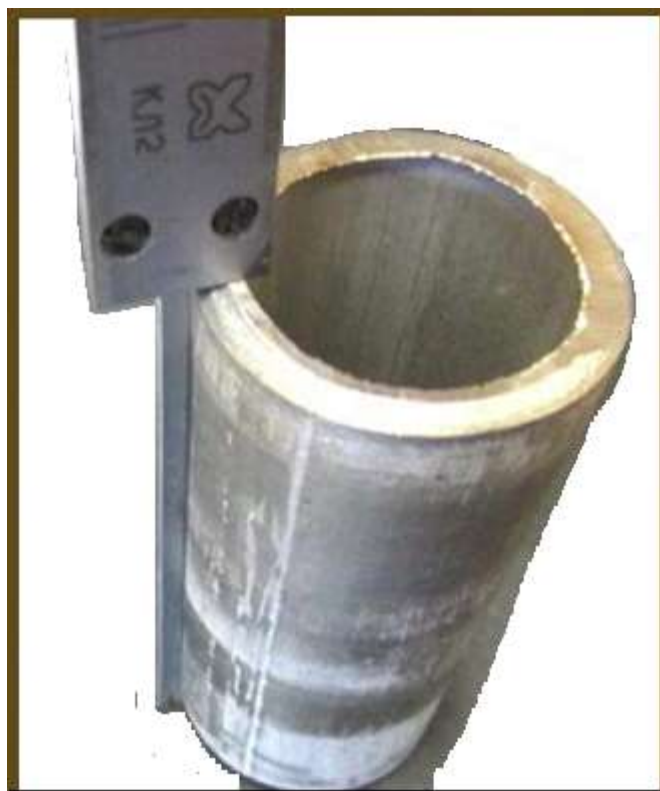
Рис. 17. Измерение глубины отверстия
