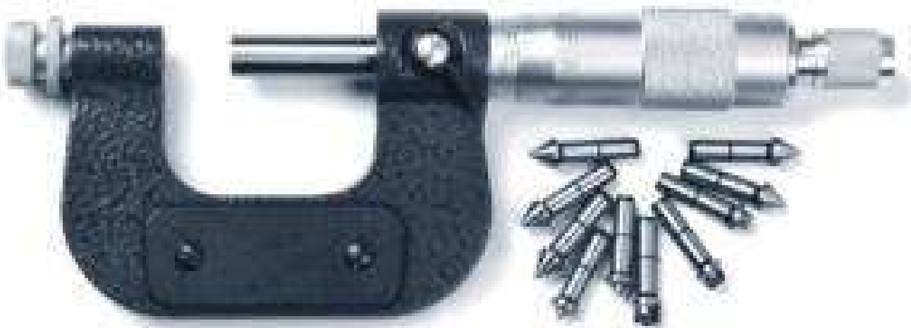
Рис. 30. Микрометр со вставками МВМ/МВУ
