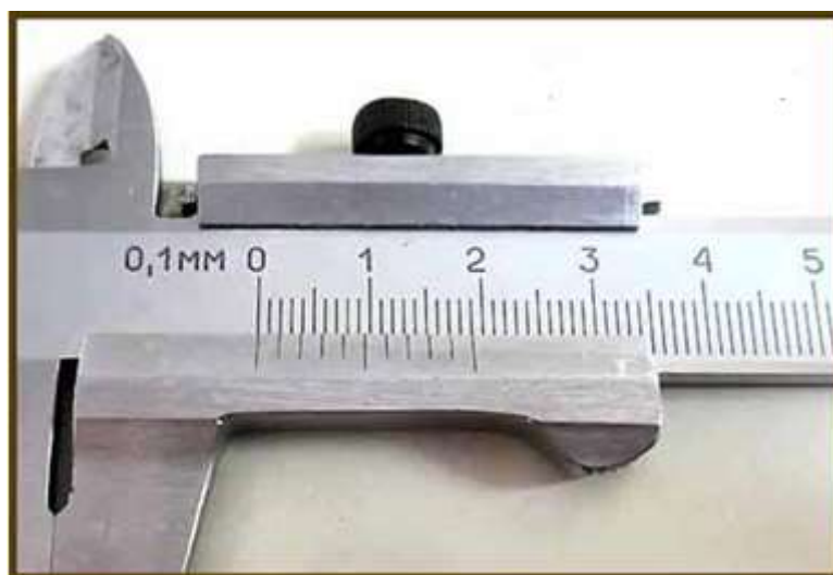
Рис. 10. Основная шкала на штанге и дополнительная на рамке
