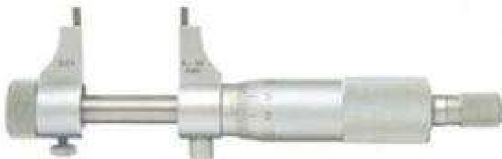
Рис. 35. Микрометры для внутренних измерений
