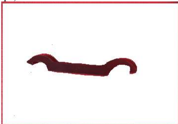
Рис. 47. Инструмент для настройки микрометра на «ноль»
