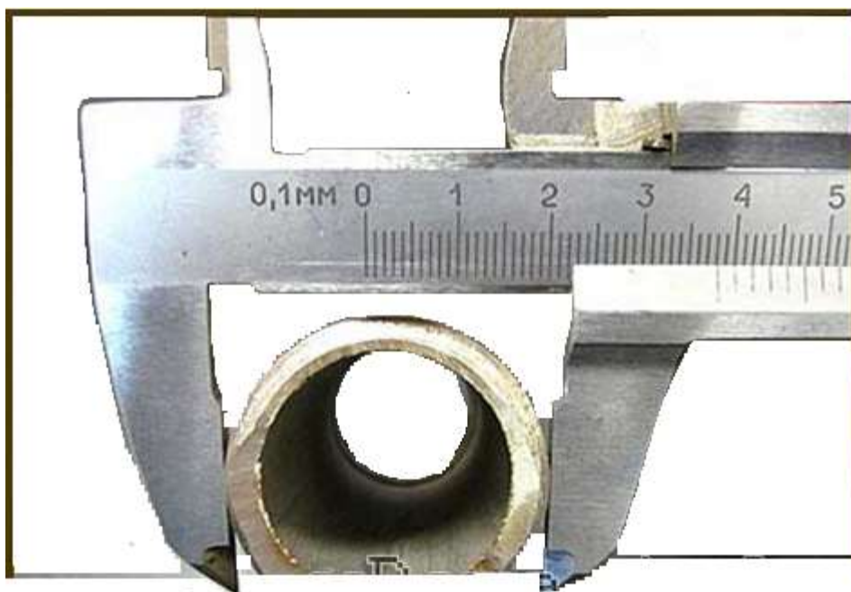
Рис. 14. Измерение наружного диаметра трубы
