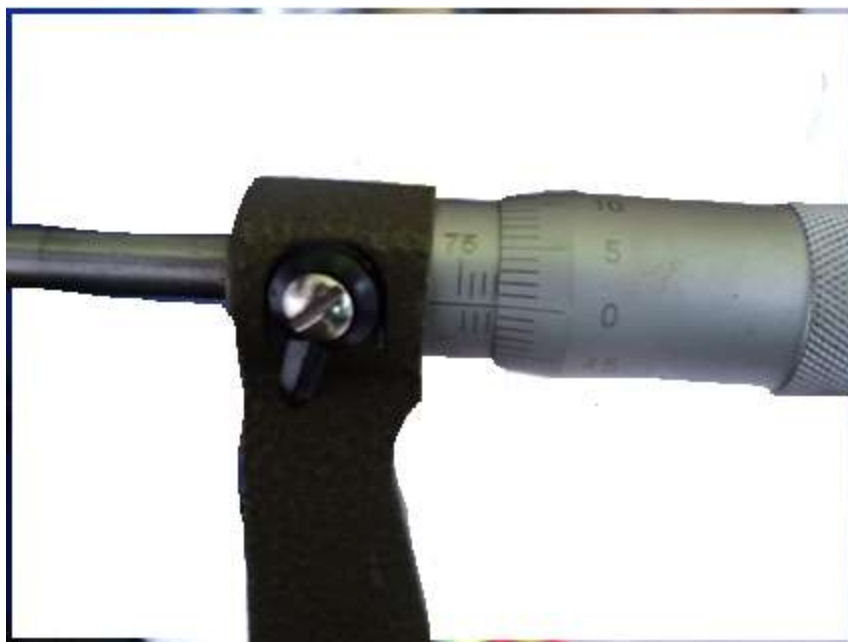
Рис. 48. Установка микрометра на размер
